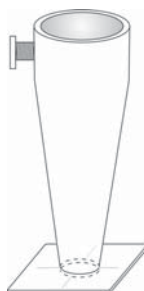
Rys. 2. Podstawka do tyczki geodezyjnej (rozwiązanie własne autora) Fig. 2. Survey rod stand (author's design)
