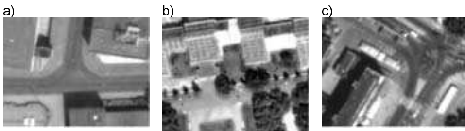
Rys. 4. Elementy infrastruktury przydatne jako fotopunkty ze względu na znajomość ich położenia (jednak zdecydowanie mniej czytelne na obrazie)
