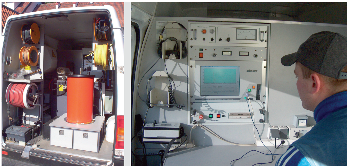
Fot. 1. Wóz pomiarowy z zainstalowanym systemem OWTS-25
