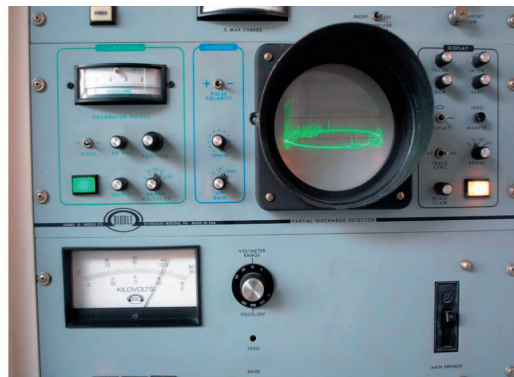
Fot. 2. Obraz wyładowań niepełnych w trakcie badania wadliwej mufy aparaturą firmy James G. Biddle Co.
