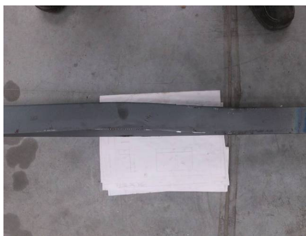
Rys. 7. Widok na zwichrowaną ściankę boczną ceownika będącą wynikiem kształtowania z wąskim wzornikiem
