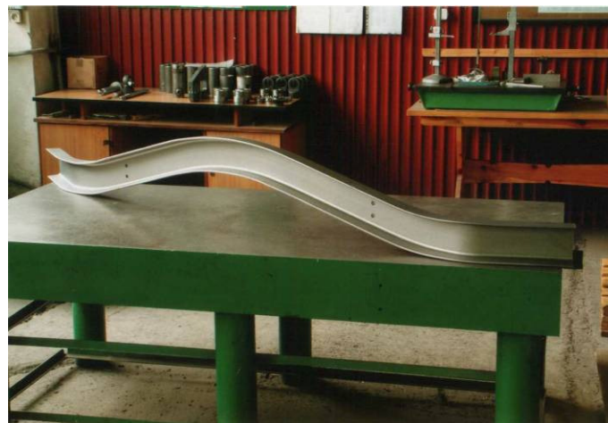
Rys. 11. Prawdłowo ukształtowany ceownik po procesie technologicznym obejmującym wykonanie otworów i śrutowanie
