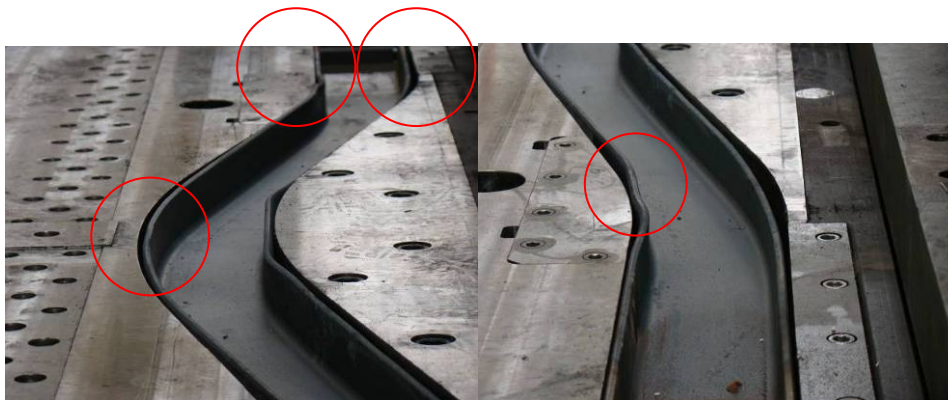
Rys. 6. Wady wyrobu po kształtowaniu ze zbyt wąskim wzornikiem
