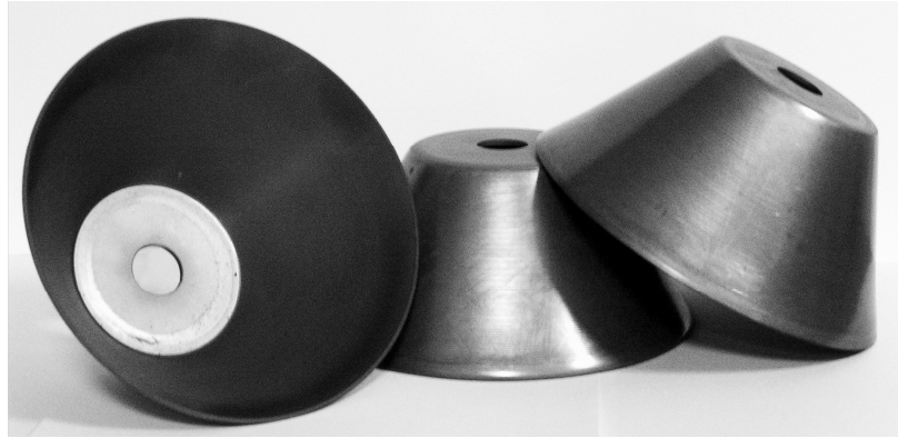
Rys. 4. Wyroby z materiału Hastelloy C-276 otrzymane metodą wyoblania
