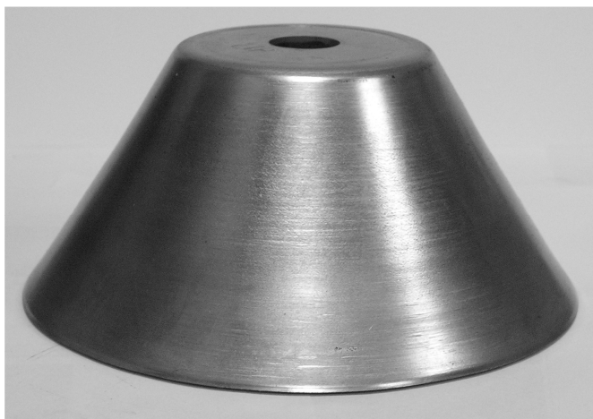
Rys. 5. Gotowy wyrób uzyskany metodą wyoblania dla posuwu 0,012 m/s
