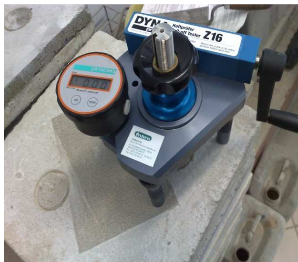
Rys. 1. Etap ustawiania urządzenia do pomiaru DYNA Z16 nad krążkiem i zerowanie licznika
