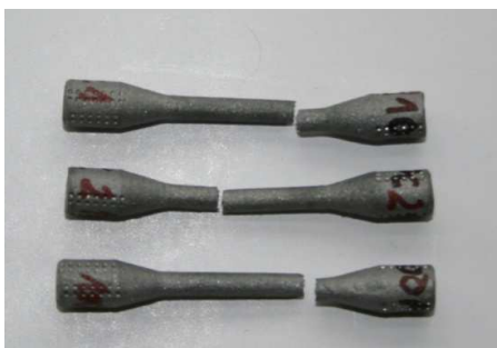
Rys. 3. Typowe miejsca pęknięcia próbek w teście rozciągania
