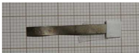
Rys. 3. Próбка IPMC przystosowana do badań czujnikiem laserowym
