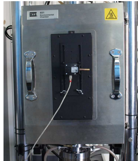
Rys. 2. Konfiguracja konstrukcji nośnej wraz z uchwytami, komorą środowiskową oraz wideoekstensometrem
