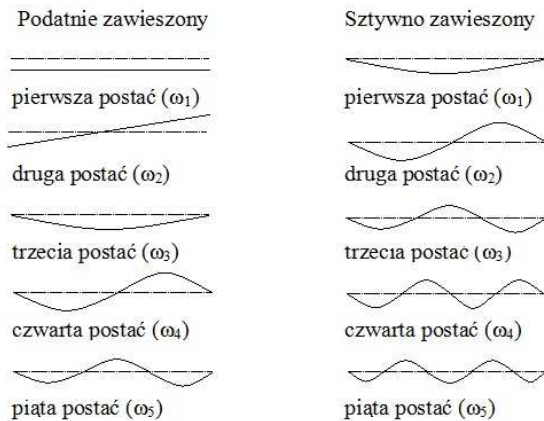
Rys. 2. Postacie drgań wirnika sztywno i podatnie zawieszony
