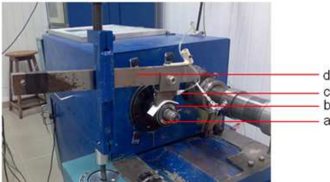
Rys. 2. Stanowisko badawcze – węzeł tarcowy: a – nakładka na czop wału, b – łożysko, c – iglica dozująca środek smarny, d – ramię, przez które przekazywane jest obciążenie
