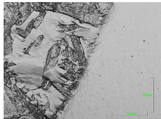
Rys. 13. Mikrostruktura obszaru granicznego, spoina – materiał podstawowy, od strony stali ferrytycznej, spoiwo C
