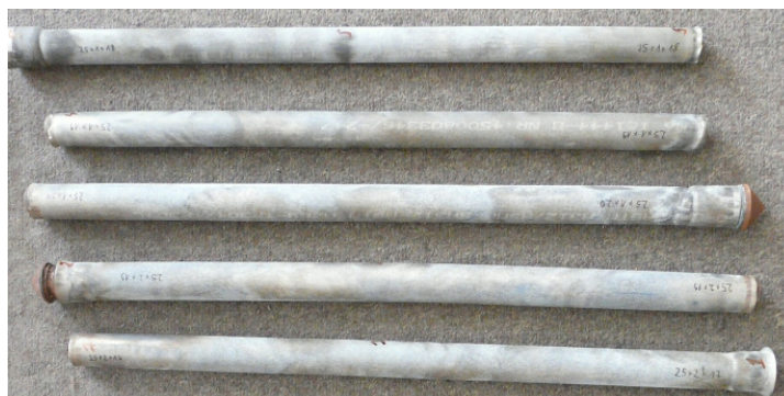
Rys. 3. Pręty bimetalowe po zgrzewaniu wybuchowym Fig. 3. Bimetallic bars after explosive welding
