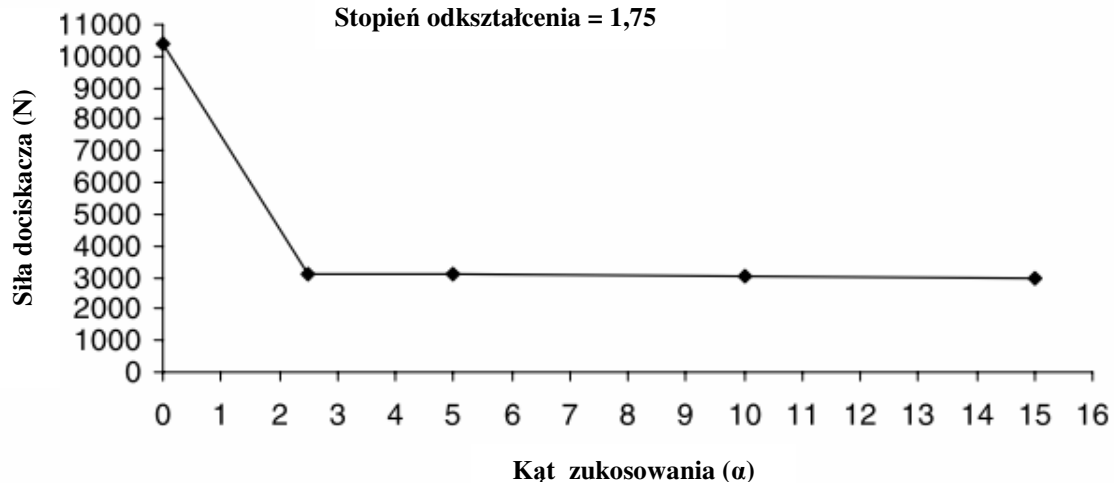
Rys. 7. Zależność siły dociskacza w stosunku do kąta zukosowania powierzchni roboczej matrycy i dociskacza ( \alpha ) [5]
