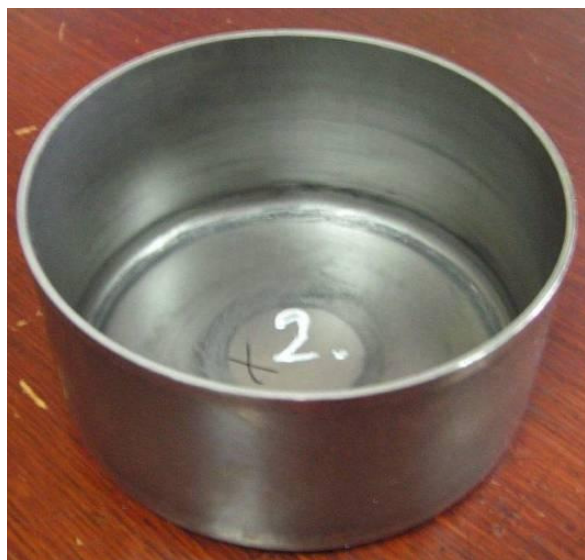
Rys. 1. Wytłoczka cylindryczna z nadstopu niklu Inconel 625 [1]
