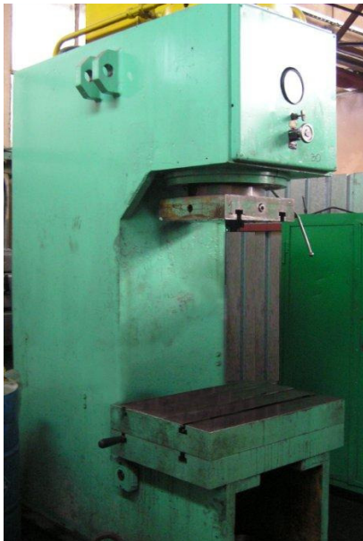
Rys. 10. Stanowisko doświadczalne do tłoczenia wytłoczek cylindrycznych [11]: a) prasa hydrauliczna PYE-250, b) tłocznik doświadczalny; 1 – stempel, 2 – matryca, 3 – dociskacz
