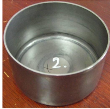
Rys. 9. Wytłoczka cylindryczna z nadstopu niklu Inconel 625 [11] Fig. 9. A cylindrical drawpiece of Inconel 625 nickel superalloy [11]
