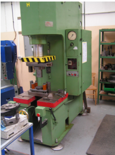
Rys. 5. Stanowisko doświadczalne do tłoczenia wytłoczki prostokątnej: a) prasa hydrauliczna PHF 63, b) tłocznik doświadczalny zamontowany na stole prasy; 1 – stempel, 2 – matryca, 3 – zespół dociskacza [3, 12] Fig. 5. Experimental stand for making the rectangular drawpiece: a) PHF 63 hydraulic press, b) experimental stamping die mounted on the press table; 1 – punch, 2 – die, 3 – blankholder unit [3, 12]
