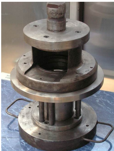
Rys. 4. Tłocznik do tłoczenia wytłoczek ze stopu Hastelloy C-276 Fig. 4. Stamping die for stamping drawpieces of the Hastelloy C-276 alloy
