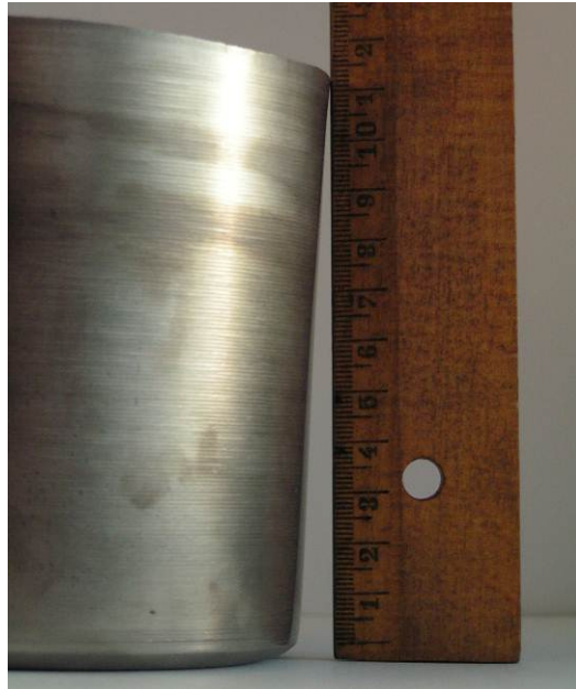
Rys. 10. Odsprężynowanie wytłoczki ze stopu Hastelloy C-276 po procesie zgniatania obrotowego Fig. 10. Hastelloy C-276 drawpiece springback after the process of flow forming
