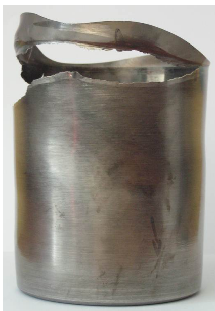
Rys. 9. Zerwanie materiału o grubości ścianki 0,67 mm
