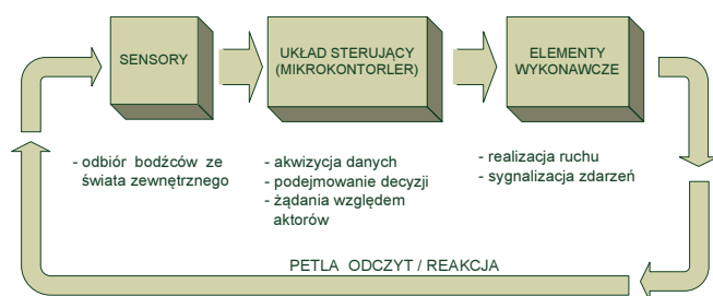
Rys.1. Pętla odczytu sensorów i wynikowej reakcji silników
