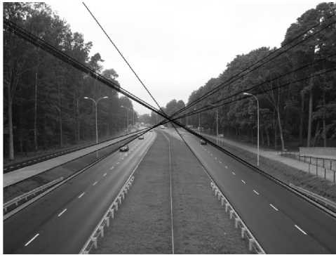
Rys. 3. Najdłuższe linie proste wyodrębnione na obrazie tworzą bezpieczny obszar lotu
