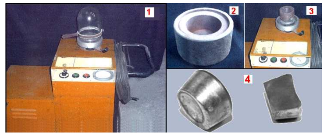
Rys. 3. Stanowisko do badania porowatości stopów aluminium: 1 – widok gazymetru, 2 – kokila, 3 – gazymetr przygotowany do badań, 4 – odlana próbka
