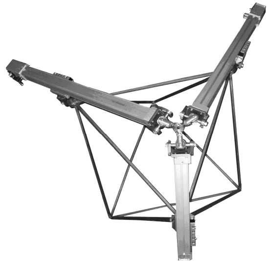
Rys. 2. Prototyp pneumatycznego manipulatora równoległego typu 3-UPU
