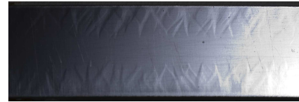
Rys. 6. Poślizgi plastyczne w belce zginanej stałym momentem
