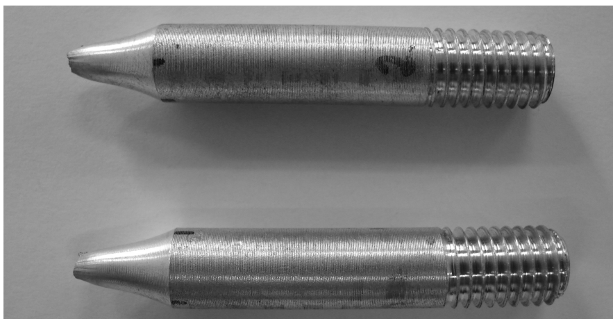
Rys. 3. Próbkę ze stopu MA2 zerwaną w próbie rozciągania na symulatorze Gleeble 3800
