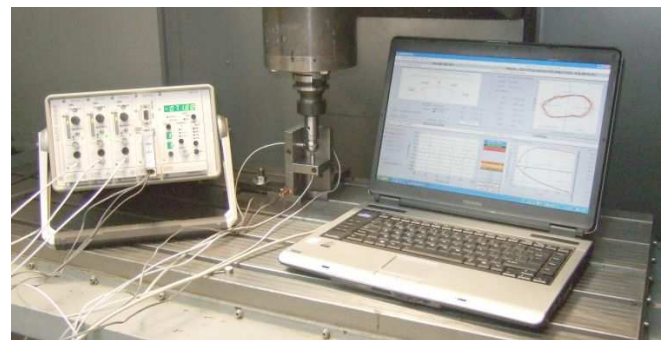
Rys. 1. Pomiar błędów wirującego wrzeciona
