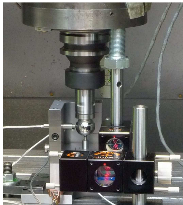
Rys. 6. Jednoczesne pomiary przemieszczeń drgań korpusu i przemieszczeń wirującej osi
