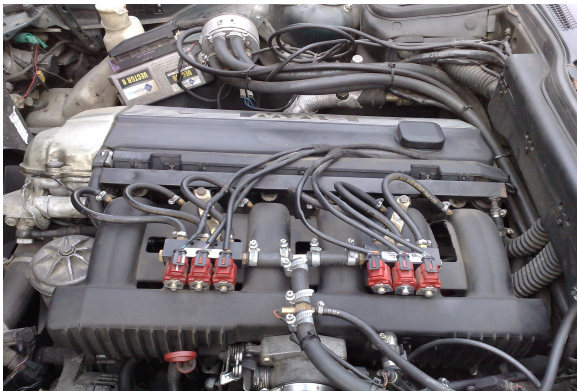
Rys. 2. Silnik M50B20 wyposażony w sekwencyjną instalację LPG
