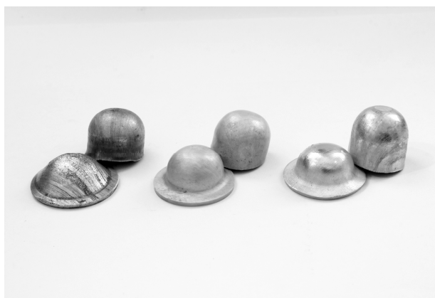
Rys. 17. Wytłoczki ze stopów Al-7075, AZ31 i AZ91 uzyskane z prasówki KOBO przez szybkie tłoczeni odpowiednio przy temperaturze 450 °C (stop aluminium) i 350 °C (stopy magnezu) [12]
