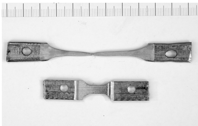
Rys. 16. Obrazy dokumentujące nadplastyczny charakter deformacji próbki ze stopu AZ91 (stop odlewniczy) w warunkach rozciągania przy temperaturze 350 °C [12]
