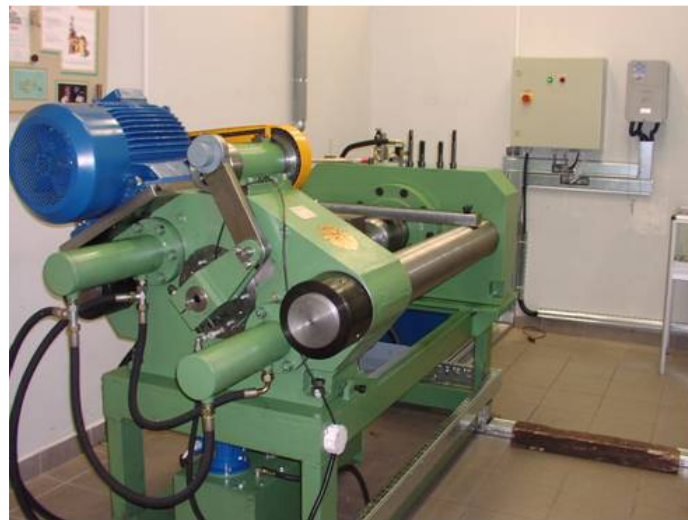
Rys. 6. Prototypowa prasa typu KOBO o maksymalnym nacisku 1 MN Fig. 6. Semi-industrial 1 MN KOBO press
