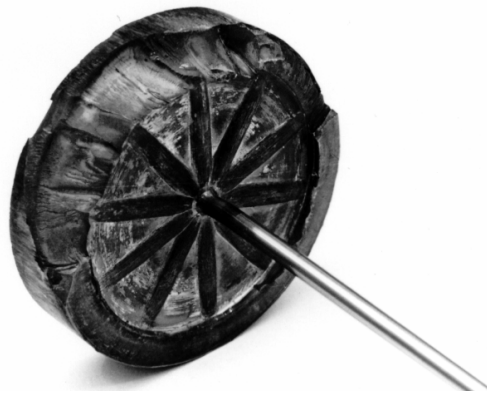
Rys. 8. „Piętka” i produkt wyciskania zimnego aluminium ze stopniem przerobu 700
