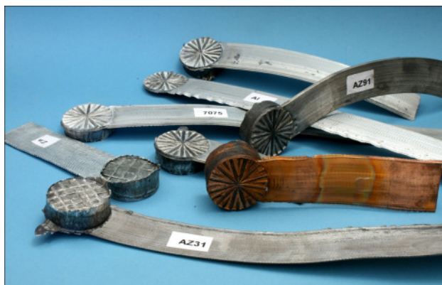
Rys. 10. Wypraski różnych metali, uzyskane drogą „bocznego wyciskania” na zimno metodą KOBO na prasie o nacisku 1 MN
