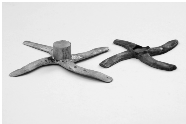
Rys. 18. Wypraski ze stopów Al7075 i AZ91 uzyskane z prasówek KOBO przez szybkie prasowanie odpowiednio przy 450°C (stop Al) i 350°C [12]
