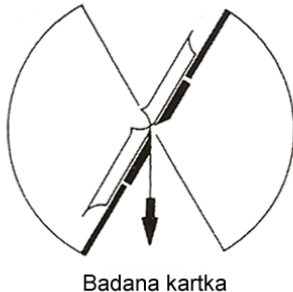
Rys. 2. Schemat przeprowadzenia badania na kartkowanie Flex Test (Clark, 1997)
