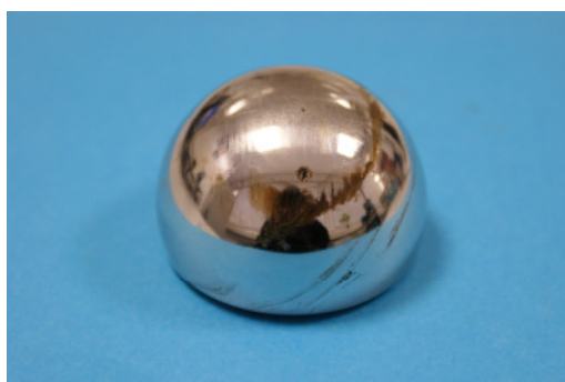
Rys. 12. Głowa endoprotezy po teście na symulatorze SBT-01 z widocznym śladem zatarcia Fig. 12. Endoprosthesis head after the test with the use of SBT-01 simulator – visible traces of seizure
