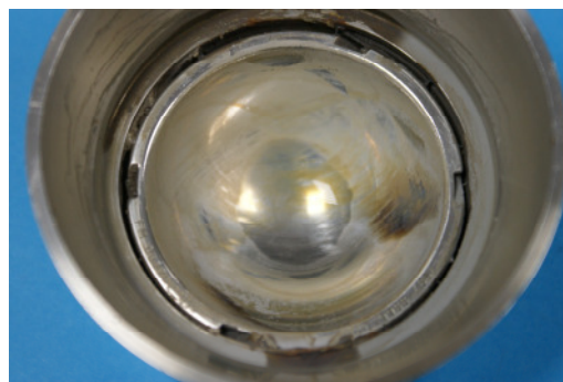
Rys. 11. Panewka metalowa po teście zakończonym zatarciem Fig. 11. Metal acetabulum after the test ending with seizure
