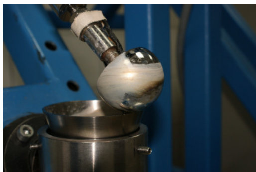
Rys. 10. Głowa endoprotezy z widocznym śladem zatarcia oraz warstwą cementu kostnego na powierzchni Fig. 10. Endoprosthesis head with visible seizure traces and bone cement on the surface
