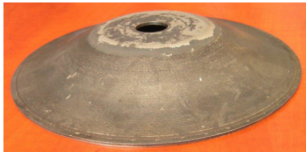
Rys. 13. Próbkę po pierwszym zabiegu wyoblania z podgrzewaniem laserowym
