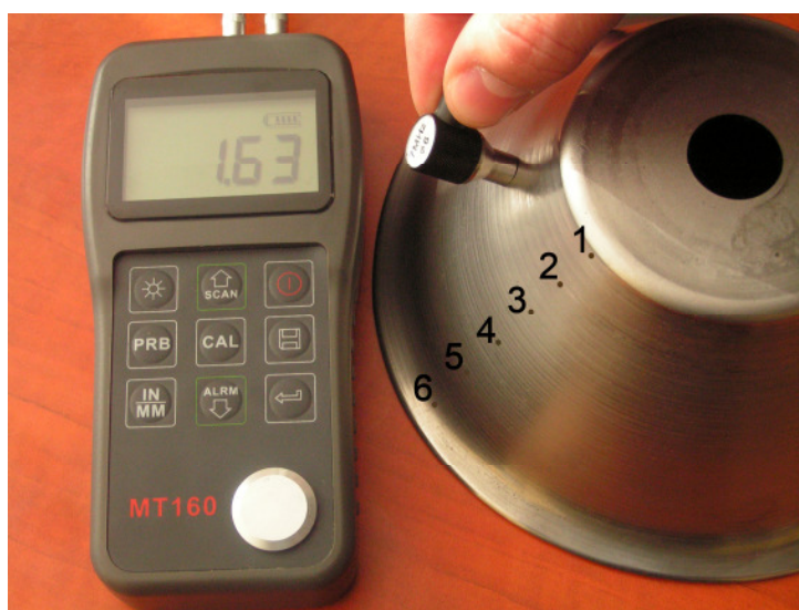
Rys. 11. Badanie grubości ścianki wytłoczki za pomocą grubościomierza z sondą ultradźwiękową Oznaczenia: 1-6 – punkty pomiarowe
