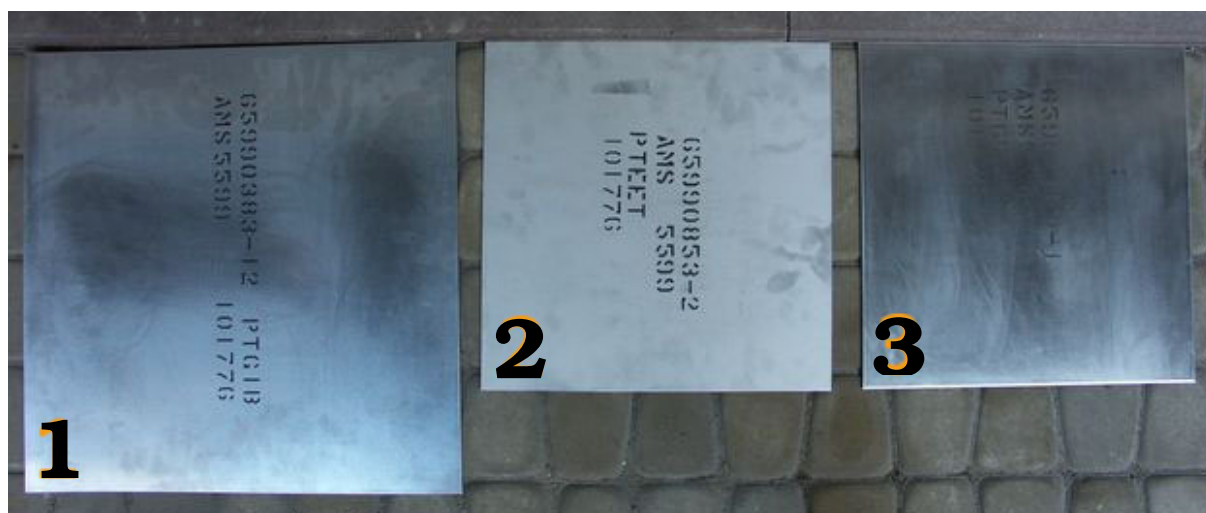
Rys. 1. Widok blach przed wycięciem próbek wraz z ich oznaczeniami używanymi w czasie badań [1]
