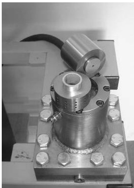
Rys. 4. Przyrząd ciśnieniowy PC-1 do modyfikacji warstwy wierzchniej tulei
