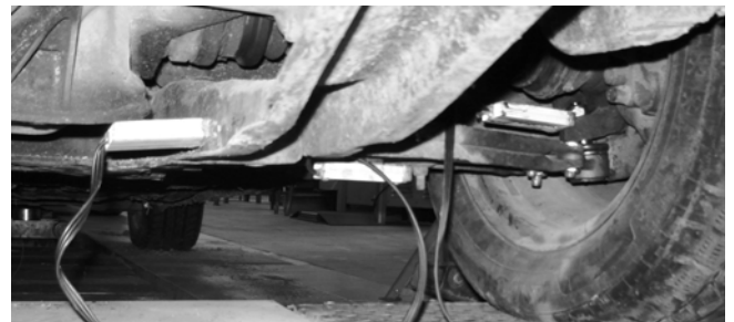
Rys. 4. Rozmieszczenie czujników w badanym zawieszeniu
