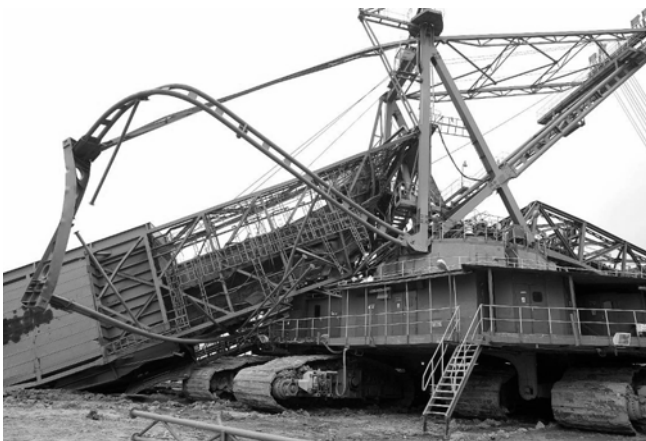
Rys. 1. Widok koparki po zerwaniu cięgna zawieszenia przeciwwagi
