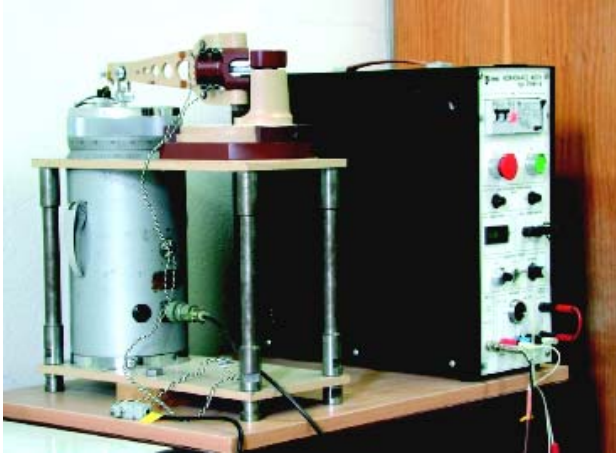
Rys. 4. Stanowisko zmęczeniowe MZGS-100L.
