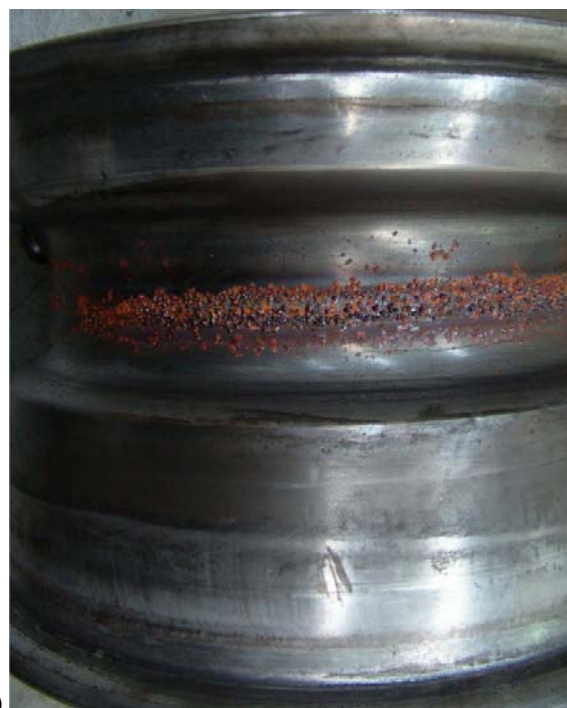
Rys. 2. Pasma korozji w górnej a) oraz środkowej b) części obręczy, zauważone po zdjęciu opony z badanego koła
