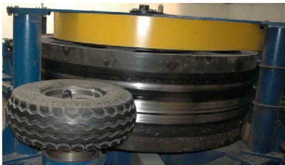
Rys. 1. Maszyna bieżniowa z badanym kołem zamocowanym w pozycji horyzontalnej
