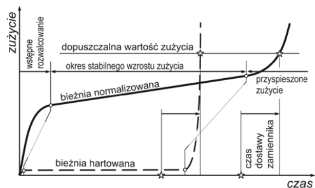
Rys. 1. Przebiegi zużycia łożyska wielkogabarytowego o bieżni normalizowanej i hartowanej
