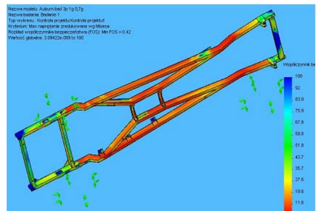
Rys. 13. Schemat rozkładu współczynnika bezpieczeństwa
