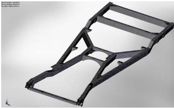
Rys. 3. Model dyskretny ramy
