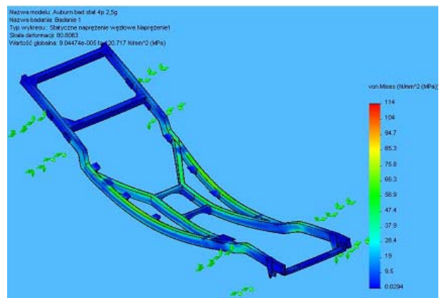
Rys. 7. Schemat rozkładu naprężeń (MPa)
