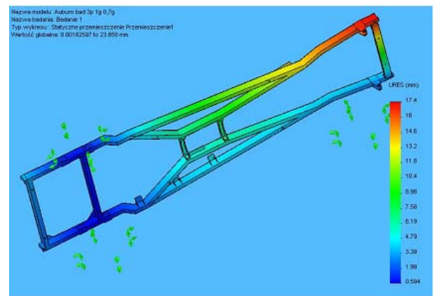
Rys. 12. Schemat rozkładu przemieszczeń (mm)
