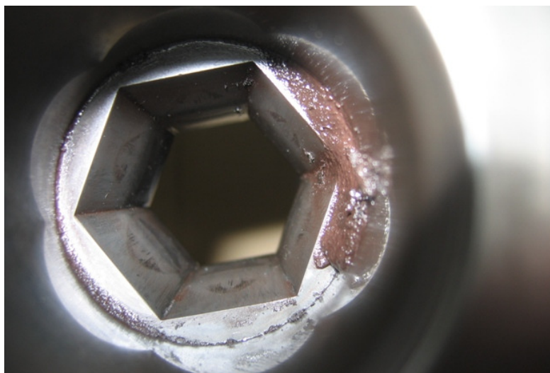
Rys. 11. Matryca do zabiegu nr 4 z węglika G40 po przetworzeniu ok. 45 000 cykli roboczych Fig. 11. Die for step no. 4 made of carbide G40 after about 45 000 working cycles
