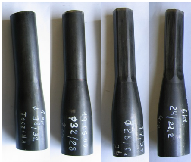
Rys. 4. Końcówki rury po kolejnych czterech zabiegach redukcji
