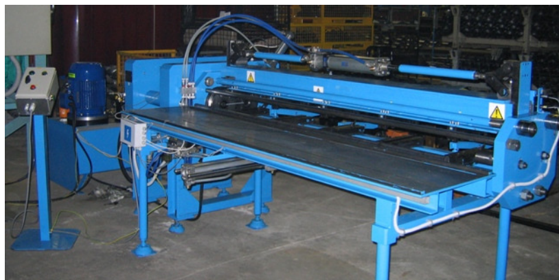
Rys. 1. Gniazdo typu UG 002/THC17 do obciskania końcówek rur
