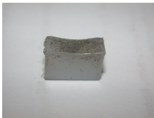
Rys. 7. Próbkę polietylenowe z wzmocnioną włóknami metalowymi warstwą wierzchnią
