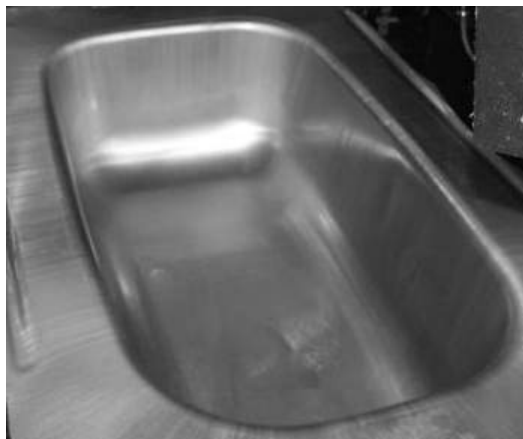
Rys. 13. Wytłoczka wanny 1200 przed operacją okrawania Fig. 13. The example view of bathtub 1200 before trimming operation
