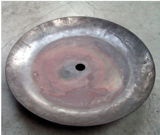
Rys. 10. Tarcza górna przepustnicy DN-700
