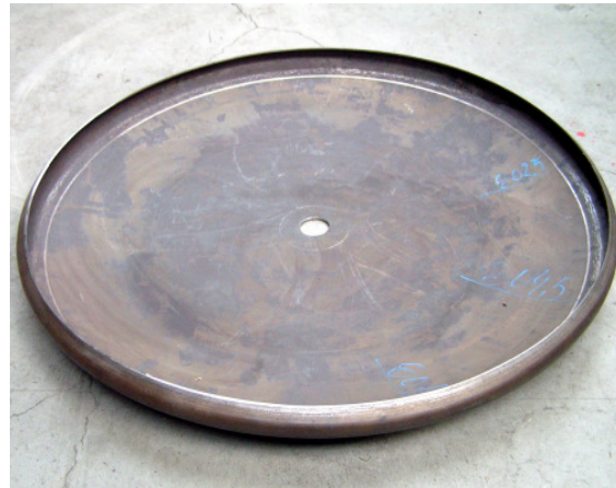
Rys. 11. Tarcza dolna przepustnicy DN-700
