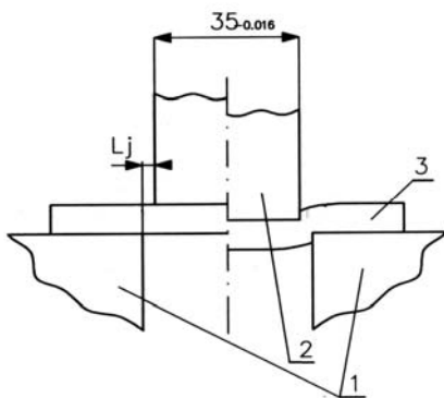
Rys. 2. Schemat przyrządu do odcinania: 1 - noże tnące, 2 - stempeł, 3 - próbka, Lj - szczelina wykrawania
