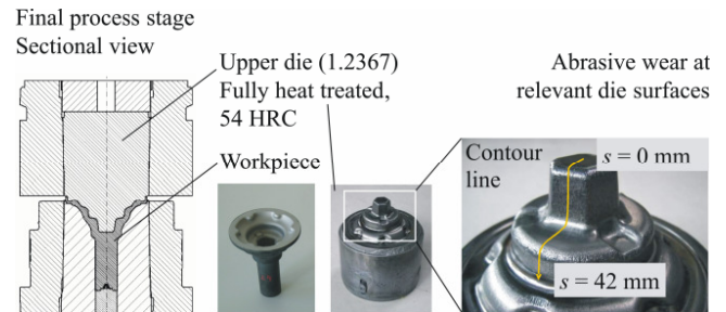
Fig. 5. Verification of the computational model regarding an industrial hot forging process of a driveshaft Rys. 5. Weryfikacja modelu komputerowego dotyczącego procesu kucia na gorąco wałka napędowego
