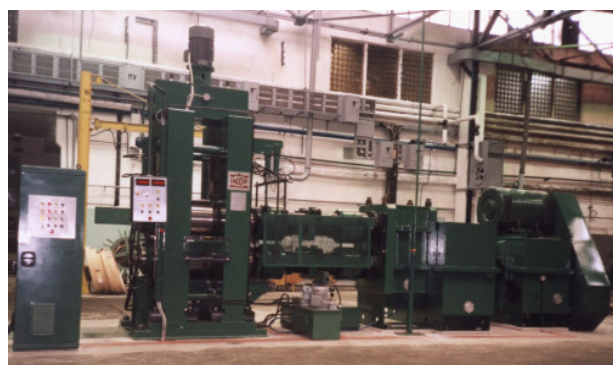
Rys. 9. Walcarka duo WDP500 do platerowania taśmy stalowej stopem łożyskowym na bazie aluminium Fig. 9. WDP500 two-high rolling mill for steel strip cladding with aluminium based bearing alloy
