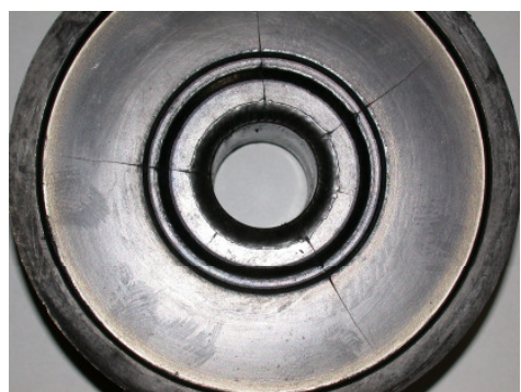
Rys. 10. Pęknięcia narzędzi do prasowania obwiedniowego: a) stempel, b) matryca
