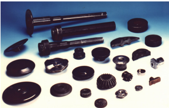
Rys. 3. Przykłady wyrobów kształtowanych obwiedniowo
