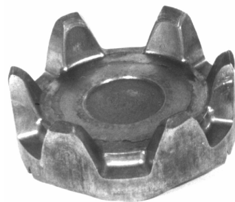
Rys. 8. Odkuwka bieguna pazurowego wirnika alternatora wykonana metodą obwiedniowego wyciskania współbieżnego [13]
