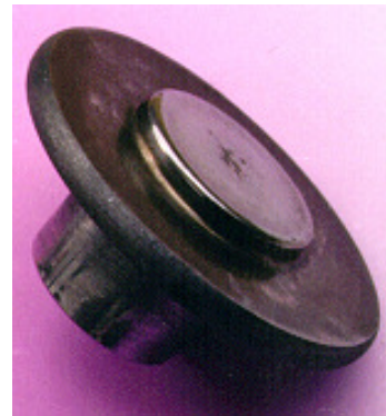
Rys. 4. Odkuwka tarczy sprzęgłowej spęczana swobodnie na prasie obwiedniowej na półgorąco[11]
