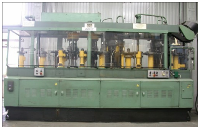
Rys. 7. Linia kołowa do produkcji wyrobów z proszków metali
