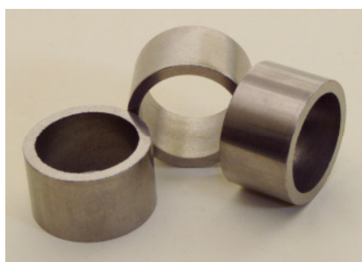
Rys. 10. Tuleje dystansowe wykonane w Instytucie Obróbki Plastycznej w Poznaniu i przygotowane do testów eksploatacyjnych przez użytkownika końcowego projektu - Liebherr Aerospace Toulouse
