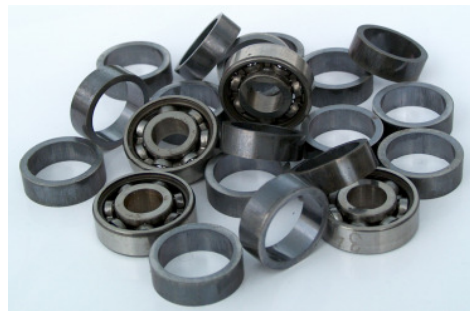
Rys. 6. Dokładne części z proszków spiekanych wykonane na linii kołowej opracowanej w Instytucie [4]
