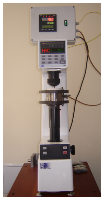
Rys. 13. Przyrząd do pomiaru twardości w podwyższonej temperaturze BT-G01
