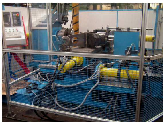
Rys. 8. Unowocześnione gniazdo badawcze technologii kształtowania obrotowego wyoblarki MZH-500 z laserem diodowym ROFIN – DL 039R
