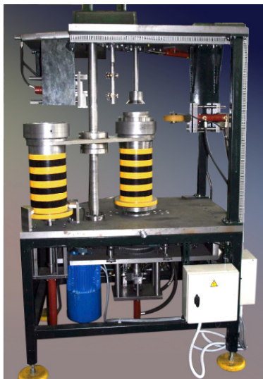
Rys. 7. Maszyna do zaginania obrzeży otulin MR-250 Fig. 7. MR-250 machine for bending lagging peripheries
