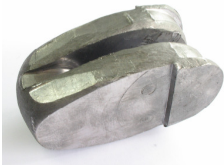
Rys. 22. Przedkuwka (a) i odkuwka modelowa (b) wykorbienia wału silnika typu 4-6S50MC wykonana według sposobu pokazanego na rys. 19b
