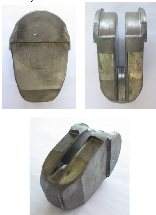
Rys. 26. Kształt odkuwki modelowej (rys. 24) po dodatkowym zabiegu kształtowania (dotłaczania) górnych części ramion
