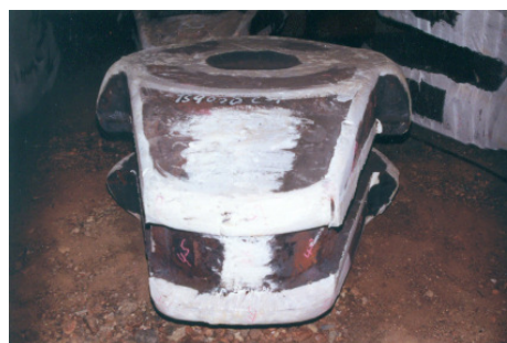
Rys. 4. Odkuwka wykorbień wału półskładanego do silnika okrętowego typu Sulzer RT58
