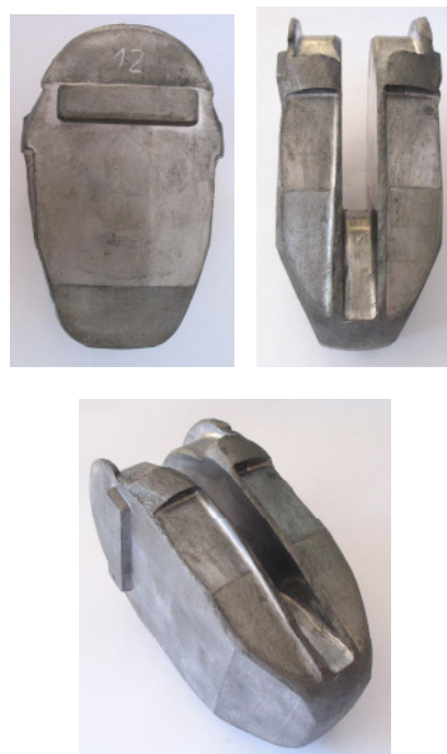
Rys. 28. Odkuwka modelowa wykorbień wału silnika typu 4-6S50MC wykonana według sposobu pokazanego na rys. 19c
