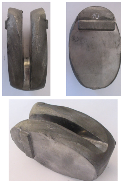
Rys. 20. Odkuwka modelowa wykorbień wału silnika typu 4-6S50MC wykonana według sposobu pokazanego na rys. 19a
