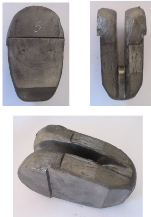
Rys. 24. Odkuwka modelowa wykorbienia wału silnika typu 4-6S50MC przy swobodnym kształtowaniu górnych części ramion
