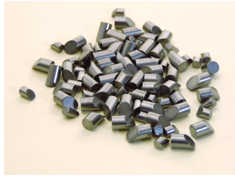
Rys. 16. Części typu klin o średnicach \phi 5 i \phi 7 mm, stosowane w przemyśle budowlanym, wykonywane z mieszanki na bazie proszku Astaloy Mo (gęstość: 7,6\text{g/cm}^3 , twardość 50-56 HRC)
