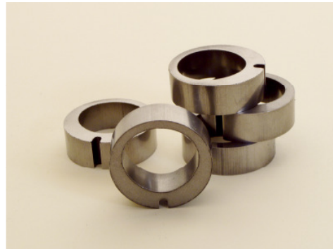
Rys. 17. Pierścienie krzywkowe wykonywane na potrzeby przemysłu samochodowego z mieszanki na bazie proszku Astaloy Mo (gęstość: 7,5\text{g/cm}^3 , twardość 50 HRC)
