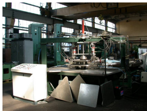
Rys. 10. Maszyna do zaginania obrzeży podkładów autostradowych znaków drogowych MZOH-1500 Miejsce wdrożenia: Znaki Gostynin Spółka z o.o., Gostynin
