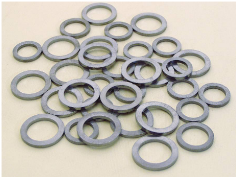
Rys. 15. Pierścienie łożyskowe w 4 typoszeregach, wykonywane z mieszanki na bazie proszku Astaloy Mo na potrzeby przemysłu włókienniczego (gęstość: 7,65\text{g/cm}^3 , twardość 60-64 HRC)
