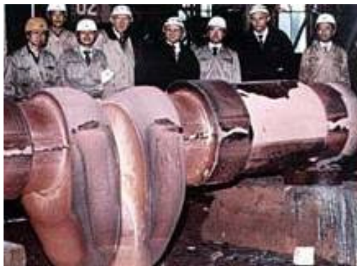
Rys. 5. Wykorbowienie wału korbowego typu Sulzer odkute wg licencji Instytutu w zakładach Japan Steel Works - Muroran Plant, Japonia
