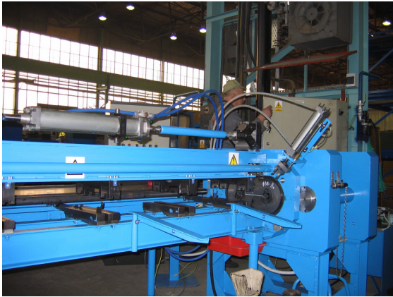
Rys. 14. Gniazdo produkcyjne obciskania rur THC-7 typ UG 002. Praca wykonana pod kierownictwem dra inż. Jerzego Grześkowiaka.
