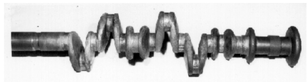
Rys. 2. Odkuwka doświadczalna wału korbowego odkutego systemem „ramię po ramieniu”
