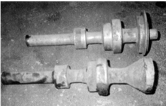
Rys. 14. Przedkuwka (1) i odkuwka (2) wałka Fig. 14. Gear-box shaft forging preform (1) and forging (2)
