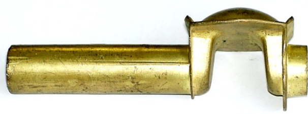
Rys. 13. Odkuwka elementu zmykającego Fig. 13. Forging of a closing element
