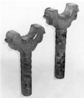
Rys. 8. Przebieg kucia drąga z łbem płaskim (a) (rys. 6d); odkuvka drąga z łbem płaskim (b); przebieg włókien w łbie odkuwki (c)
