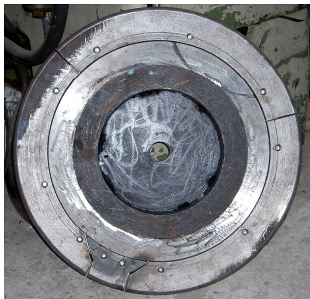
Rys. 5. Wzornik składany Fig. 5. Built-up templet
