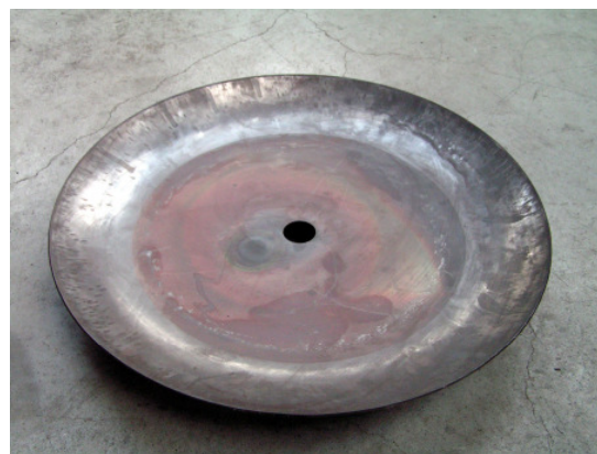
Rys. 8. Tarcza górna przepustnicy DN-600 Fig. 8. DN-600 choke upper disk
