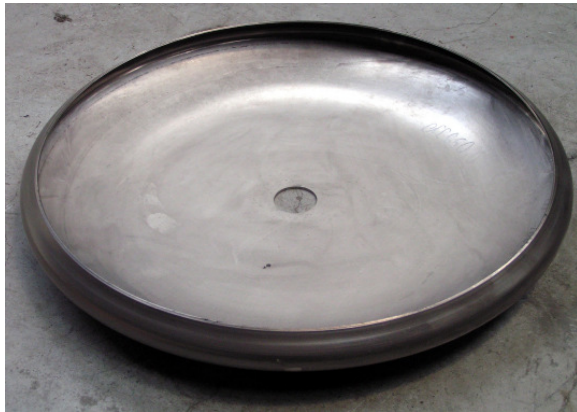
Rys. 9. Tarcza dolna przepustnicy DN-500 Fig. 9. DN-500 choke lower disk
