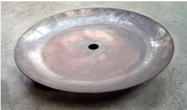
Rys. 10. Tarcza górna przepustnicy DN-500 Fig. 10. DN-500 choke upper disk
