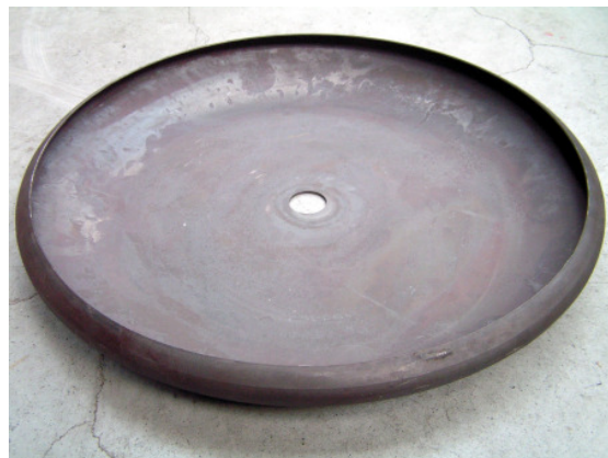
Rys. 7. Tarcza dolna przepustnicy DN-600 Fig. 7. DN-600 choke lower disk
