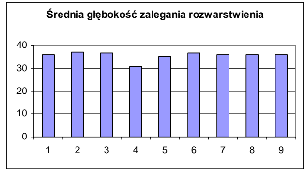
Rys. 4. Średnia głębokość zalegania rozwarstwienia w kolejnych badaniach, w obszarze reprezentatywnym
