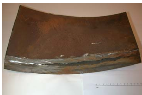
Rys. 1. Rozwarstwienie materiału kolana; przekrój poprzeczny
